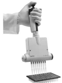
Pipette multicanaux illustrant la nouvelle gamme Pipet Lite™ XLS™
